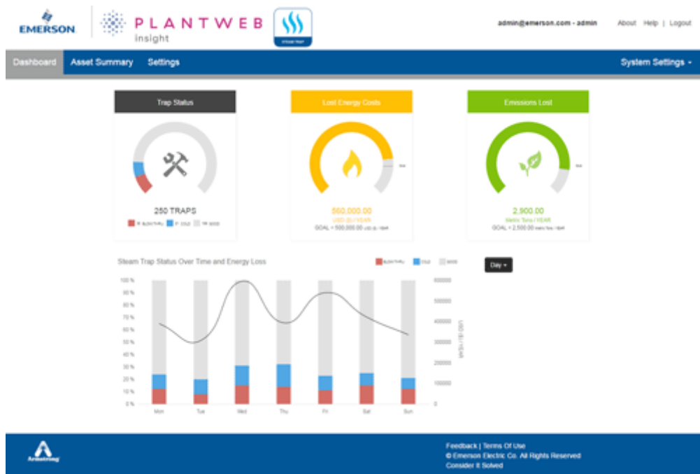
Figura 4. A tela gráfica disponibilizada pelo software analítico pode capturar e exibir informações de desempenho e condição para purgadores de vapor em toda a instalação, permitindo um programa de manutenção preditiva.
