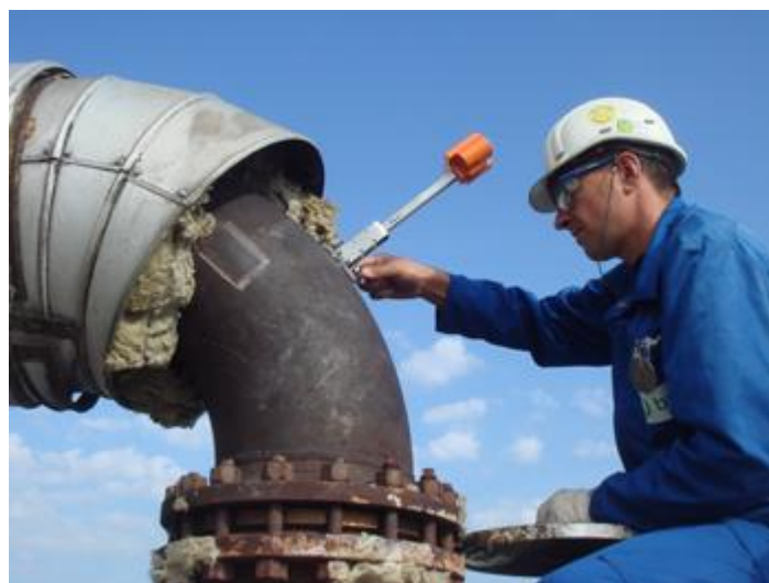
Figura 3. Instrumentos ultrassônicos de medição de espessura de metal podem ser montados no lado externo de tubulações ou paredes de vasos para medir qualquer perda de metal devida à corrosão ou erosão. Uma melhor solução é a monitoração online com sensores não intrusivos fixados no lado externo de tubulações ou vasos (figura 3). Estes sensores usam tecnologia ultrassônica para continuamente
