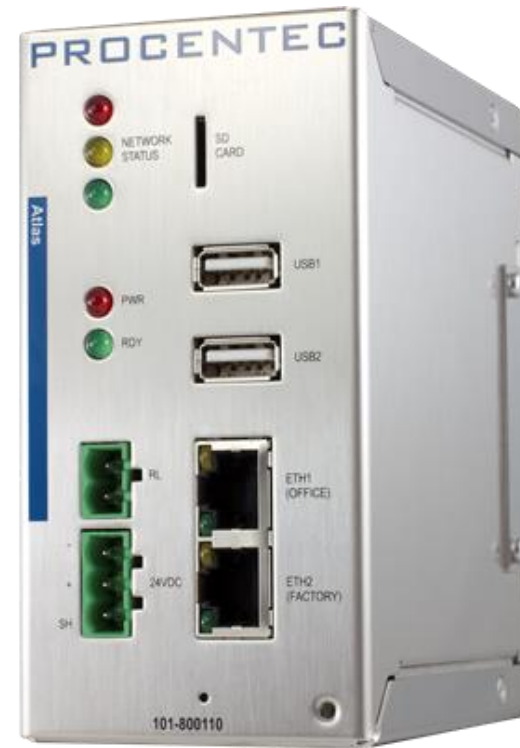
ATLAS: Monitoramento, Análise e Gerenciamento On-Line em Redes ETHERNET (PROFINET, ETHERNET IP, MODBUS TCP, etc.)
