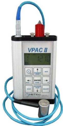
Através da emissão acústica e com o uso de um algoritmo é possível analisar a estanqueidade de uma válvula
