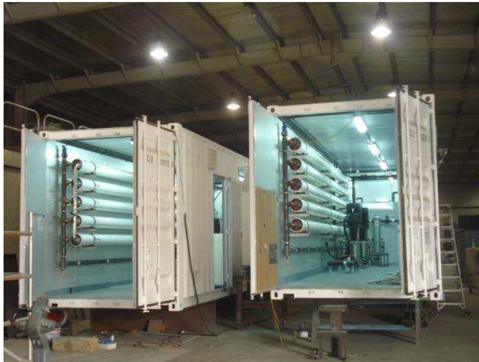
Osmosis inversa (RO) unidade com transmissor JUMO ecoTRANS LF 03 e sensor de condutividade JUMO tecLine 202924
